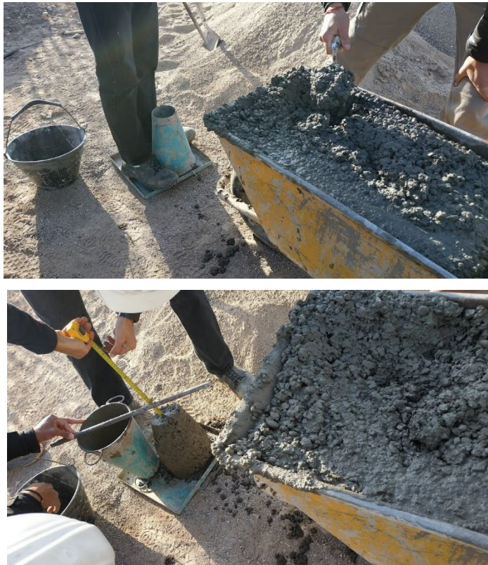
Figura 17. Ensayo de asentamiento con cono de Abrams
