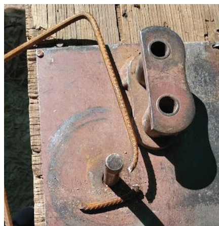
Figura 25. Verificación de doblado y fragilidad del acero por el grupo de calidad
