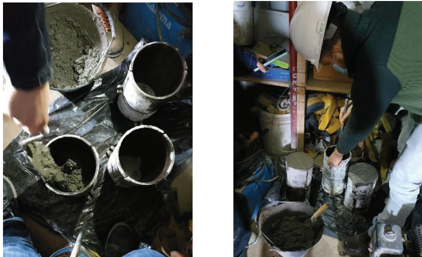
Figura 18. Confección de probetas para ensayo a compresión del hormigón
